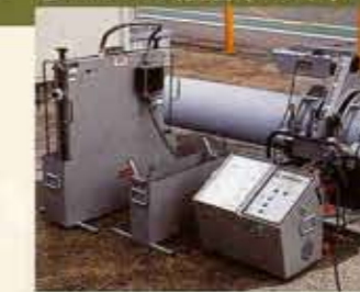
②パイプの融着(ハット)
